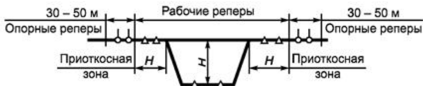
Рисунок У.2 - Схема к составлению проекта размещения реперов при открытом способе строительства подземного сооружения
